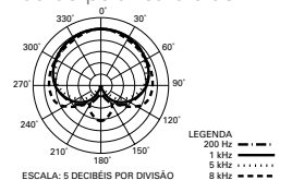
resposta de frequência de figura em oito: 20 a 18.000 Hz
