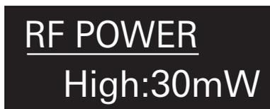
2. Premere il pulsante UP/DOWN e selezionare una delle opzioni tra [High:30mW], [Low:10mW] e [Off].
