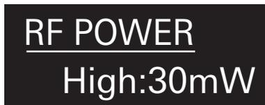
2. Pulse el botón UP/DOWN y seleccione [High:30mW], [Low:10mW] u [Off].
