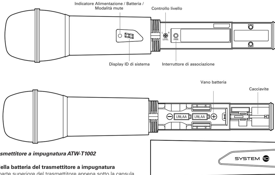
Figura H – Trasmettitore a impugnatura ATW-T1002
