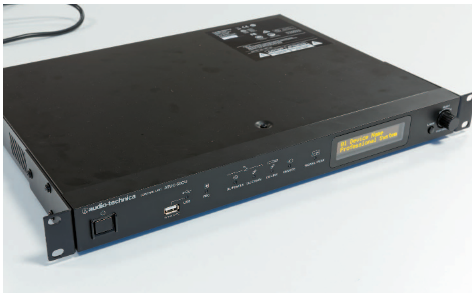
Die Zentraleinheit ATUC50-CU ist im 19"-Format gehalten und nimmt bei einem Rack-Einbau eine Höheneinheit in Anspruch – bei einer nennenswerten Gerätetiefe von mehr als 33 Zentimeter.
