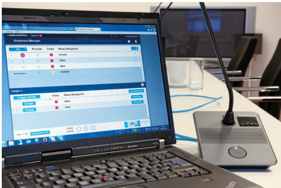
Obwohl wesentliche Funktionen direkt an der Zentraleinheit ATUC-50CU eingestellt bzw. abgerufen werden können, ist die Bedienung per Web-Browser (Web Remote) deutlich komfortabler und eröffnet darüber hinaus den Zugriff auf wesentlich mehr Parameter.
