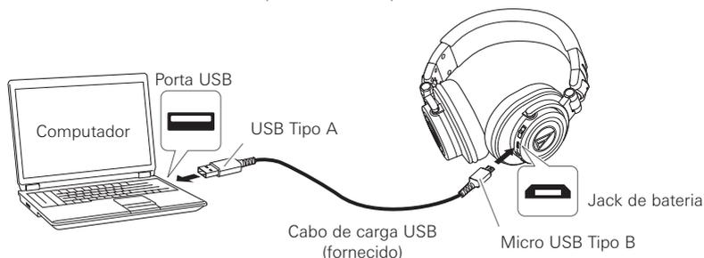
2. Conecte o cabo de carga USB fornecido (lado USB Tipo A) ao computador para iniciar o carregamento.
