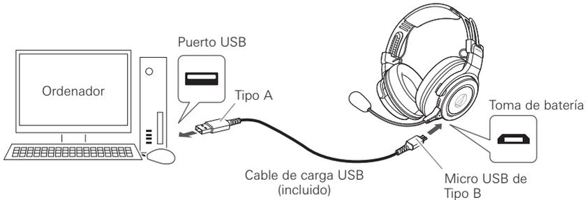
2. Conecte el cable de carga USB incluido (extremo USB de Tipo A) al ordenador para iniciar la carga.
