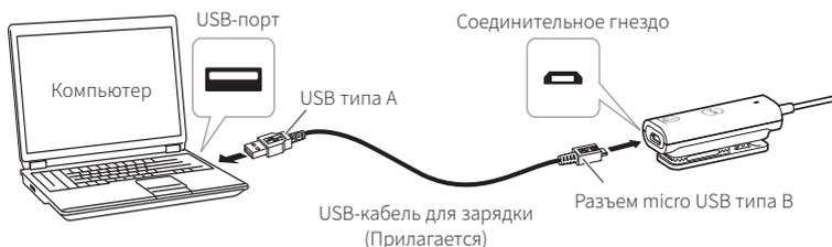
2. Подсоедините прилагаемый USB-кабель для зарядки (разъем USB типа A) к компьютеру, чтобы начать зарядку.
