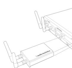
Los módulos de recepción ATW-RU13 se pueden conectar al Chasis ATW-RC13 de manera remota
